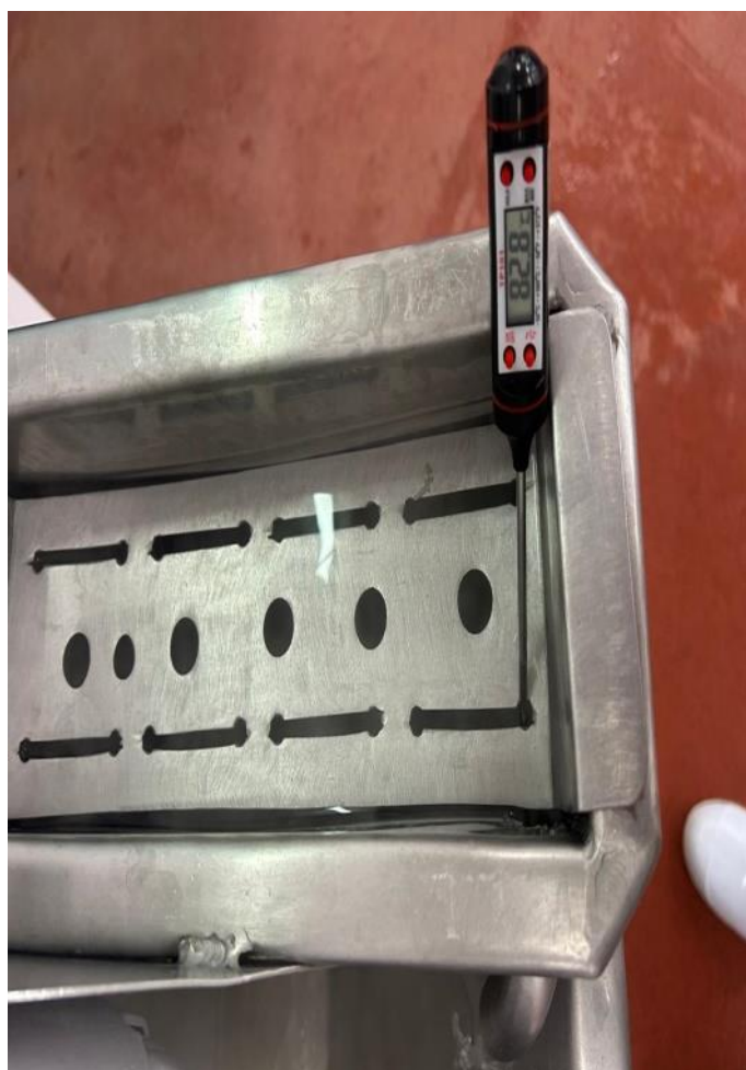
Figura 7: Aferição de temperatura de esterilizador de facas.
