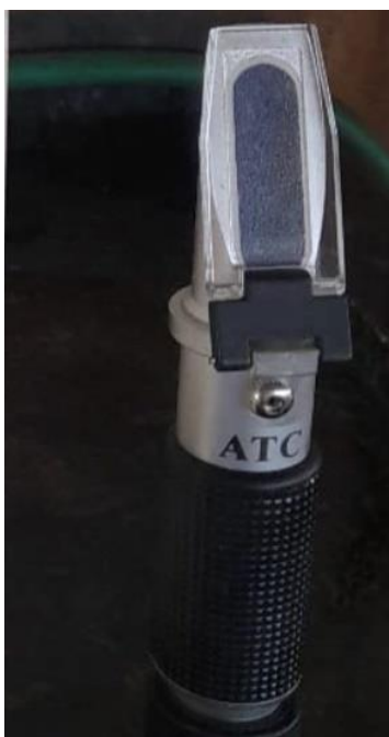
Figura 19 - Refratômetro óptico para realização do teste Brix, na Chácara Canata. Fonte: Arquivo pessoal, 2024.
