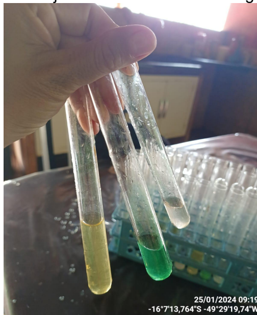
Figura 4- Análise dos parâmetros químicos demonstrando alterações na amônia devido falta de manejo e excesso de matéria orgânica na água.
