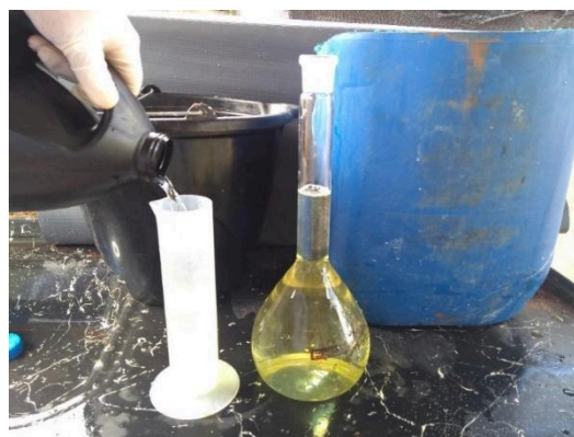
FIGURA 4- Preparação de solução de hipoclorito de sódio a 20% para imersão dos ossos para início do clareamento. Fonte arquivo 2018.
