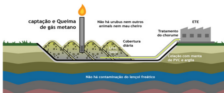
Figura 4- Estrutura do Aterro Sanitário
