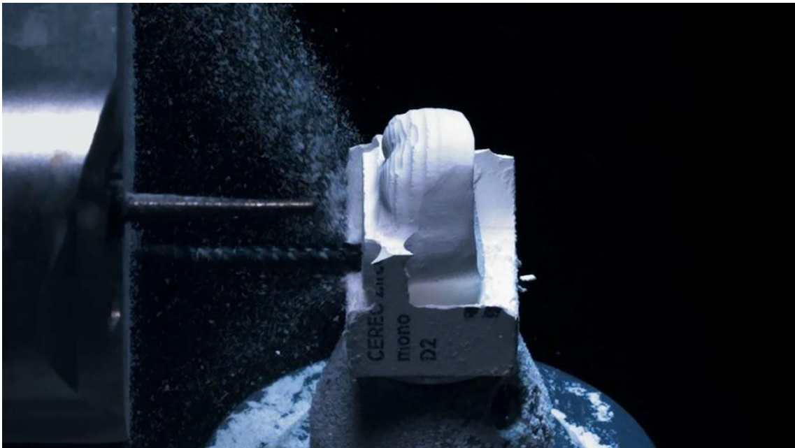
Figura 14: Diferentes brocas, fresas ou pontas diamantadas são usados dependendo do tipo de material e da opção de processamento
