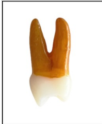
Figura 1 – Dentes artificiais (IM do Brasil, São Paulo, Brasil) produzidos em resina acrílica radiopaca com 85% de dureza da dentina.
